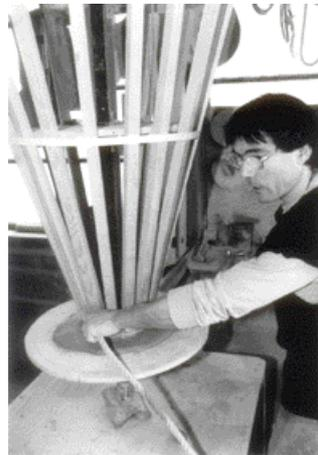
La corde a été enroulée jusqu'en haut et le profil extérieur, fermement maintenu contre une poutre mobile est approché. L'espace entre le profil et la corde détermine l'épaisseur d'argile de la future pièce. Le dessin du profil est important : c'est lui qui contribue à l'aspect extérieur de la pièce et au respect de la forme.
